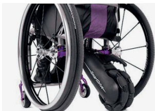
Hilfsantrieb zu Rollstuhl
